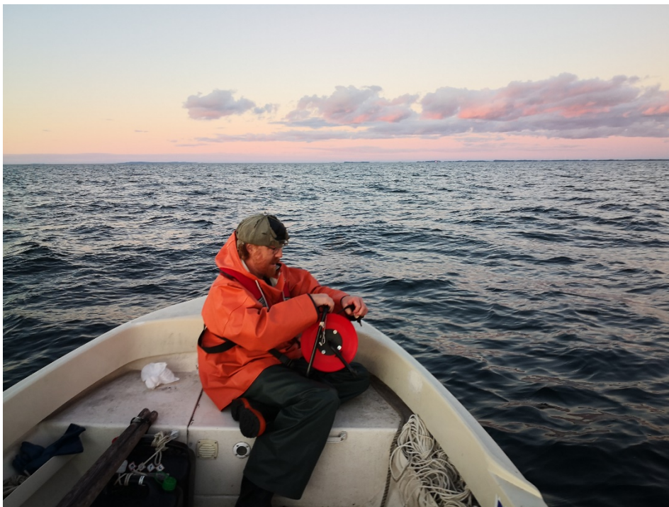
Bild 9. På varje lokal tas en temperaturprofil med hjälp av en termistor. Temperaturprofilen mäts vid provtagningspunkten som är placerad på det djupaste stället i provrutin. Foto John Persson SLU
